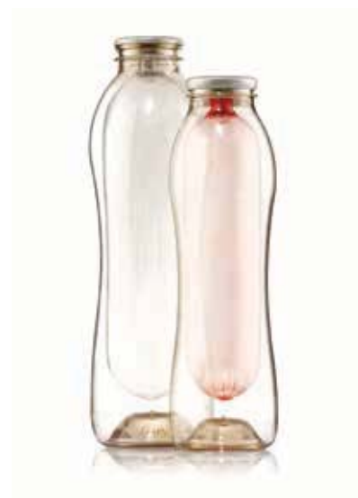
Aerozol znajdujący w woreczku Power Pouch wydostaje się z pojemnika za sprawą sprężonego gazu napędowego (propelenta), który wypełnia przestrzeń między ściankami butelki a woreczkiem z polietylenu.
