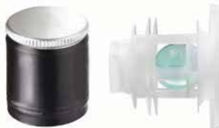
Zamknięcie Tiva 2 wyposażone jest w blokadę w postaci krążka, który zostaje złamany w momencie, gdy ktoś próbuje otworzyć butelkę.
